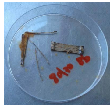
Fibre corrodibili, prova non superata
